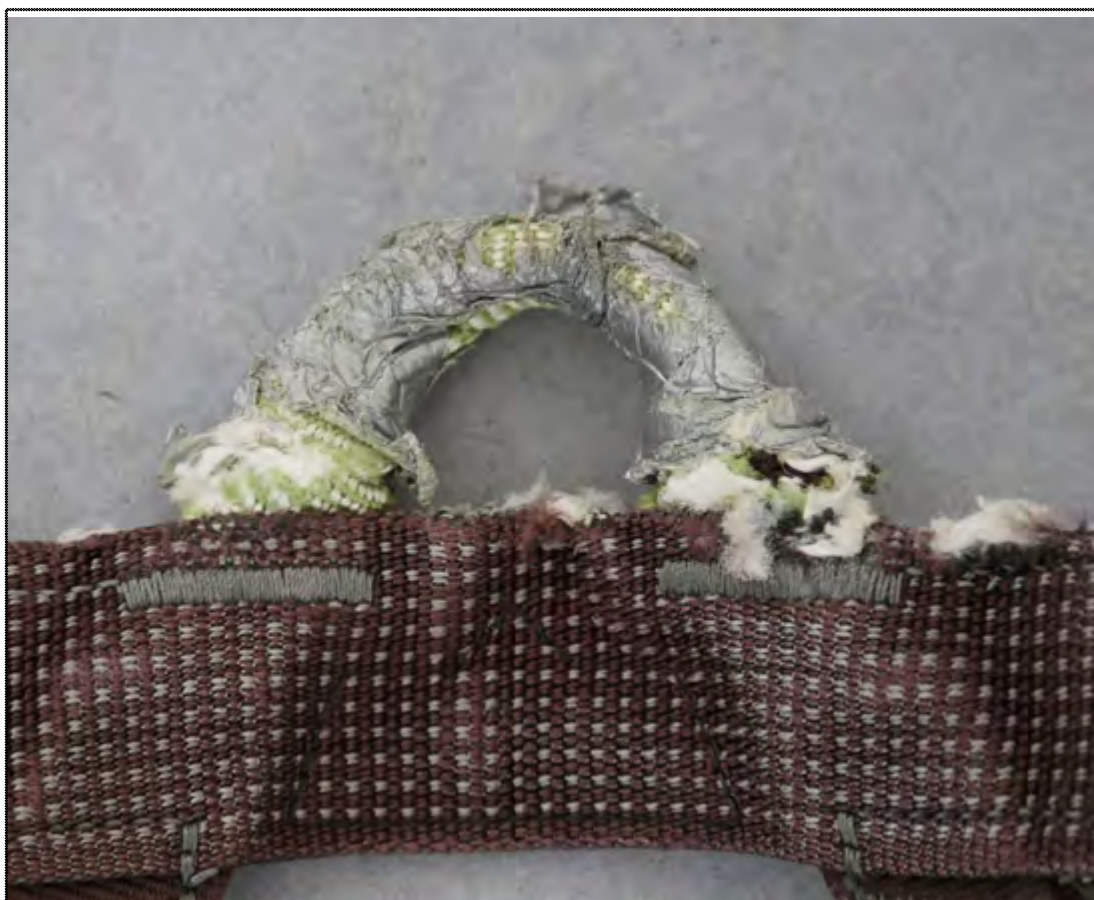
Figure 14: harnais A1 face ventrale. La sangle de protection du pontet a été complètement abrasée au niveau de la ceinture. La sangle du pontet a été également abrasée. Malgré cette usure apparente la rupture du pontet s'est effectué à 18.84kN, soit environ 20% de plus que les exigences.
