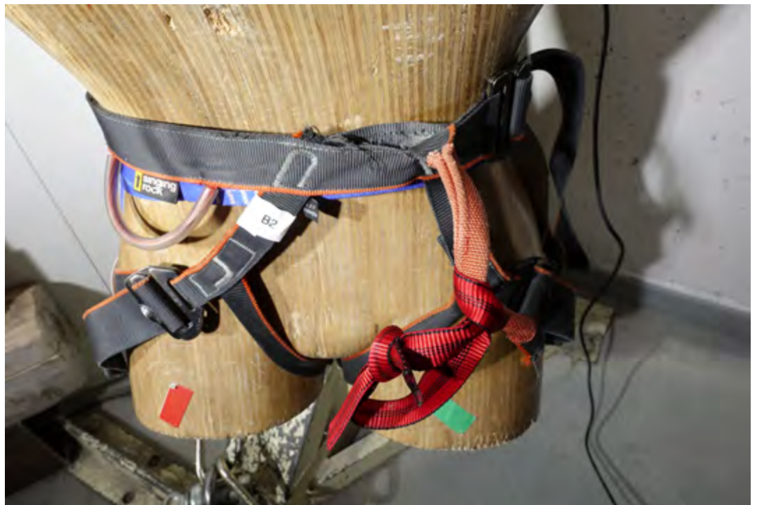
Figure 24: harnais (B2) rupture à 6.33 kN à la base du pontet au niveau de la couture lors d'un essai avec une tête d'alouette sur le pontet et un tirage désaxé.
