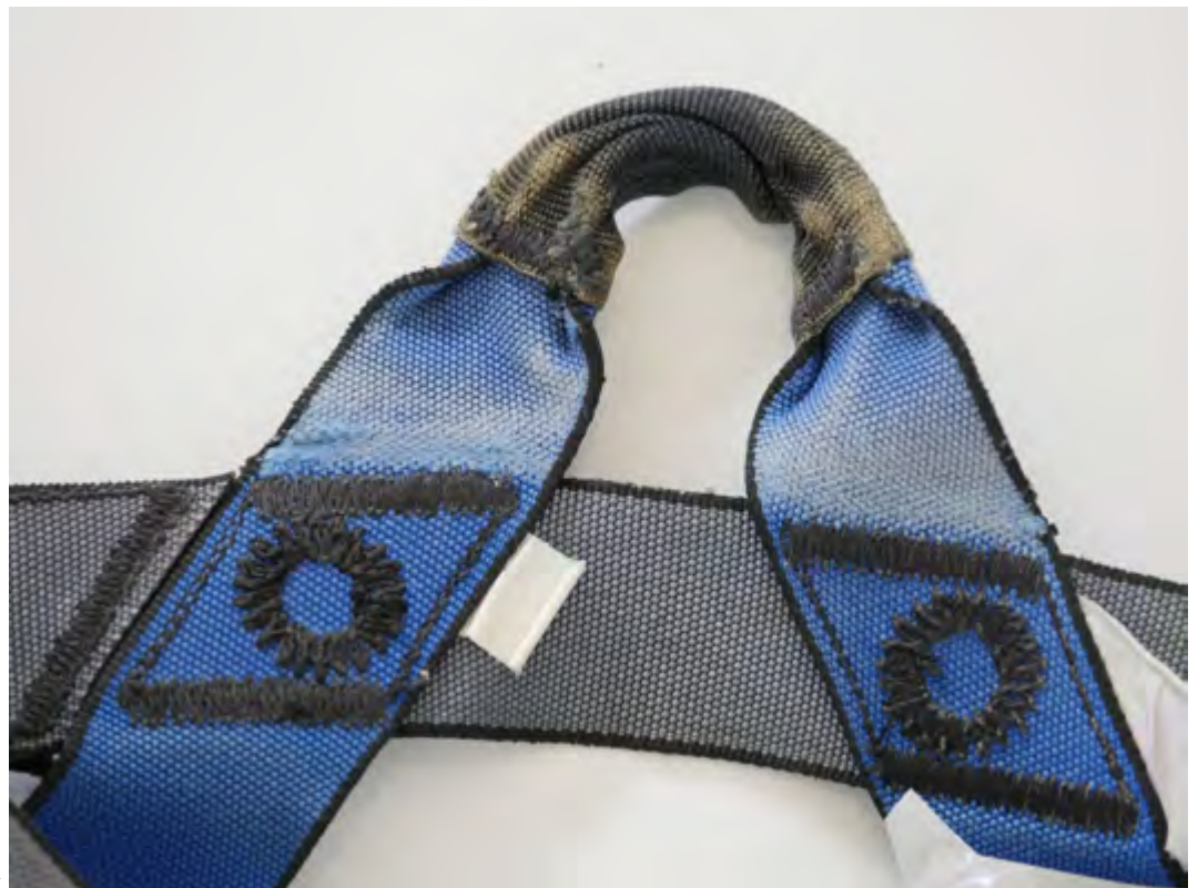
Figure 28: harnais (E4) 2013, 5 années d'utilisation, détail pontet
