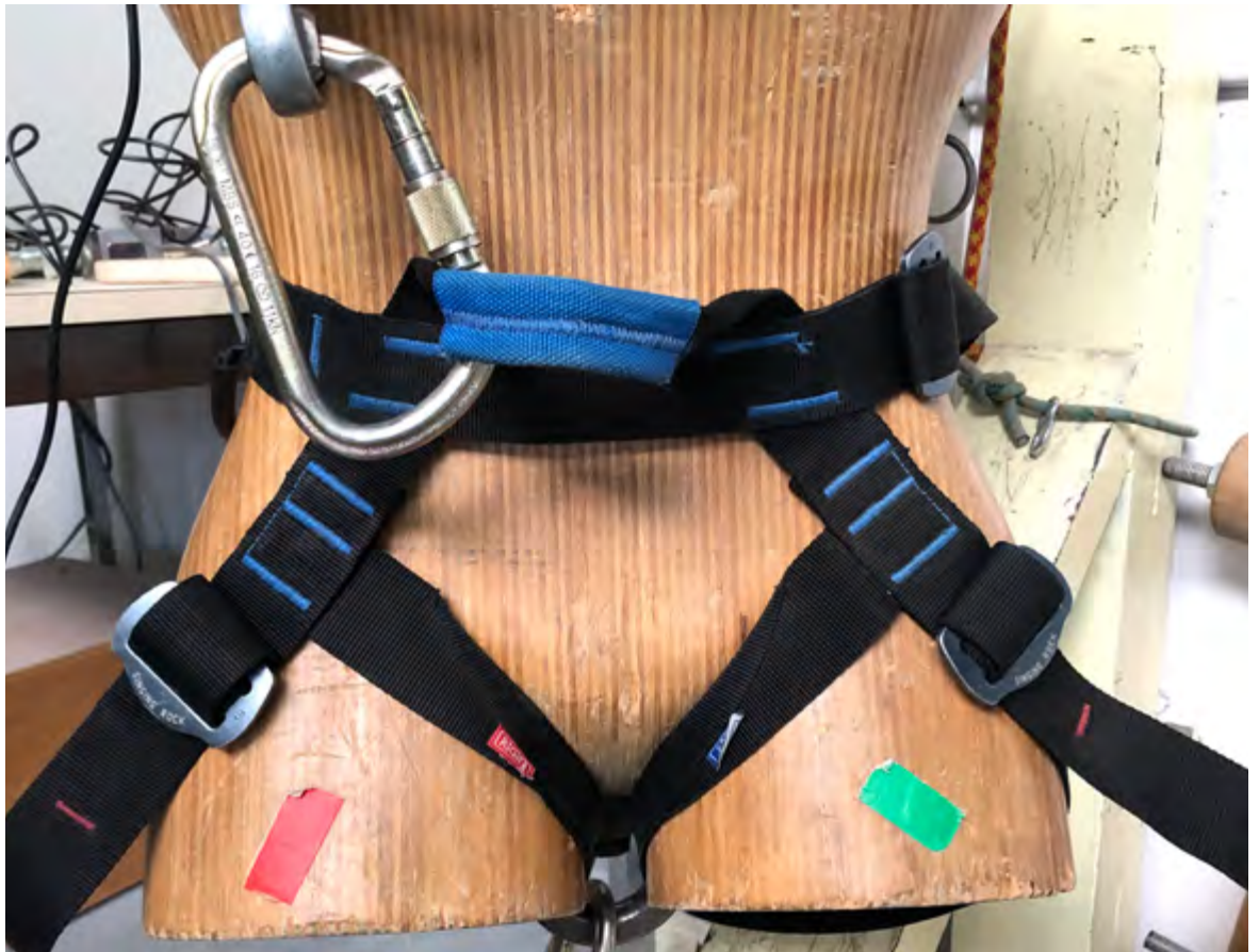
Figure 39: Harnais Singing Rock (SG1). 7 ans d'utilisation
