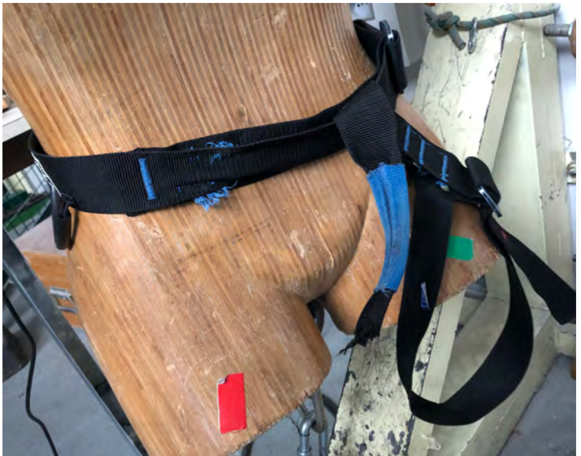
Figure 40: Harnais Singing Rock (SG1). Rupture de la cuisse à 19kN puis du pontet.
