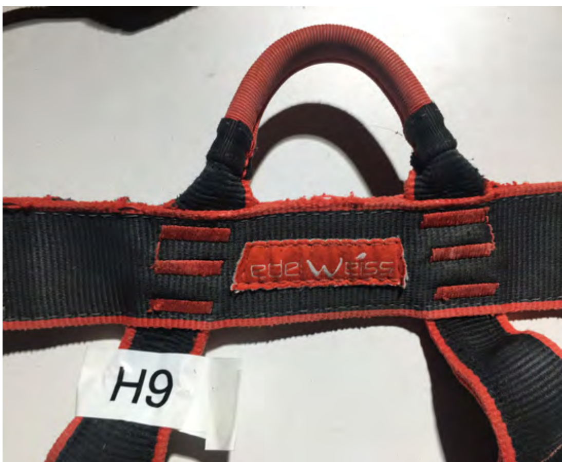
Figure 38: Harnais mygale d'edelweiss. H9. Le pontet s'est rompu à 132 daN, soit 9% de la valeur requise par la norme. La ceinture s'est rompue à 488 daN soit 49% de la valeur requise par la norme (10 kN).
