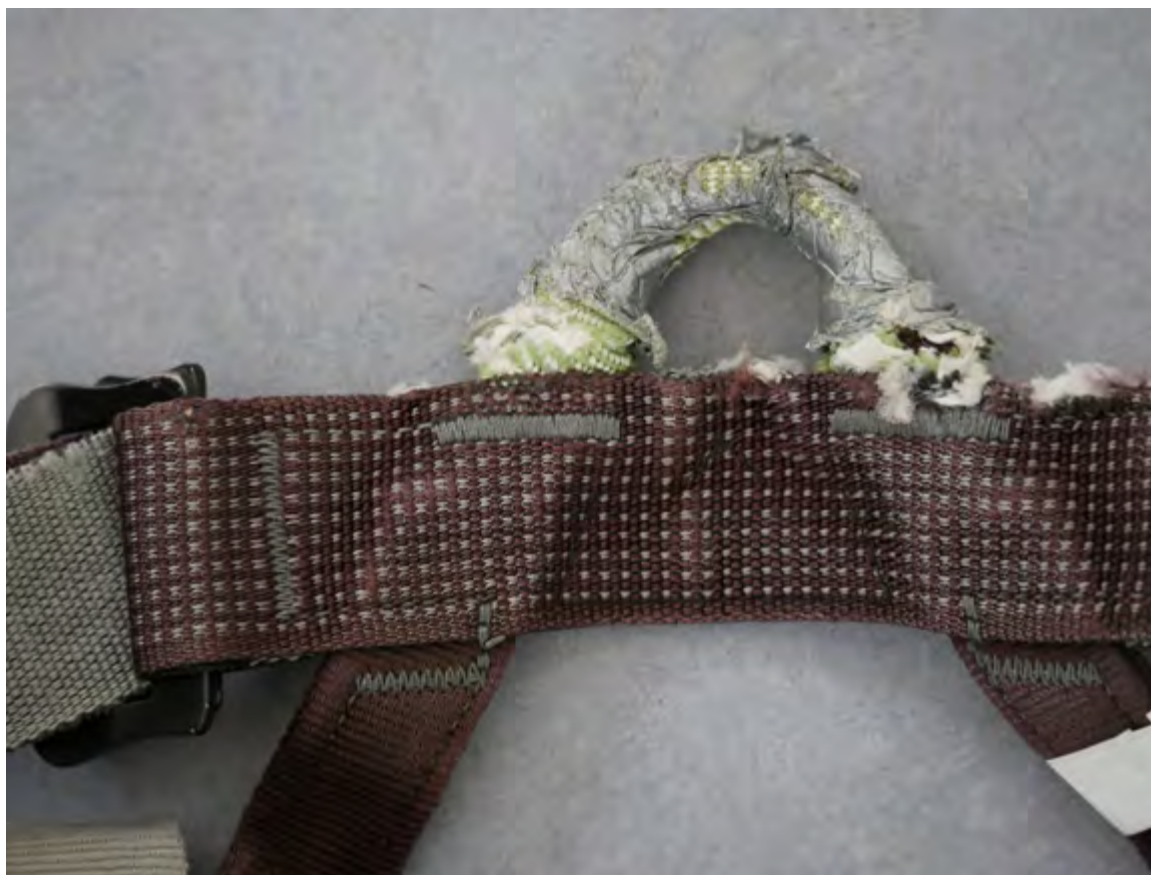
Figure 16: harnais Pandion Gordel de Petzl, (A2). Coté intérieur, la sangle de protection du pontet s'est déchirée au dessus de la couture.
