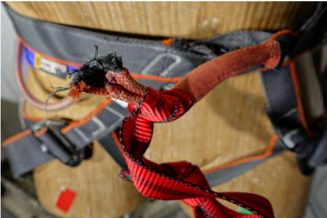
Figure 26: détail de ruptureharnais (B2) 6.33 kN
