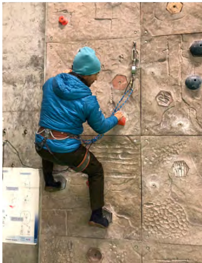
Figure 4: Position de départ pour simuler une glissade au relais. La longe du grimpeur n'est pas tendue et forme un angle de 35° avec la verticale. La force générée sur le relais est de 238 daN
