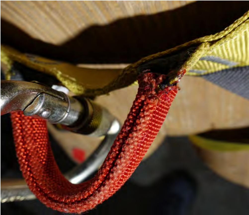
Figure 22: harnais A7. la sangle de protection a été abrasée à son extrémité ; le pontet a lui aussi été touché. Les sangles ont été brûlées pour arrêter l'effilochage.
