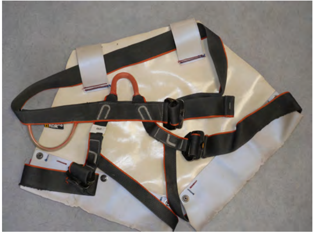
Figure 23: malgré un faible état d'usure ce harnais (B2) s'est rompu à 6.33 kN lors d'un essai avec une tête d'alouette sur le pontet et un tirage désaxé.
