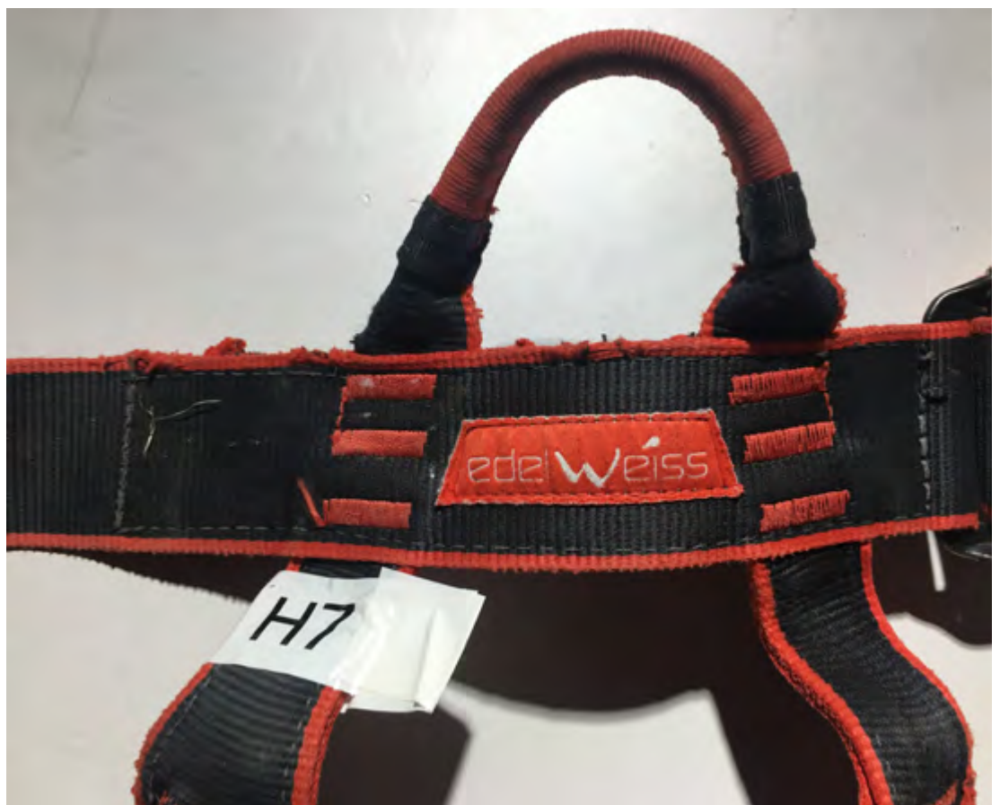
Figure 36: Détail pontet harnais mygale d'edelweiss. H7. Utilisation 3 à 5 ans. Etat : usé. Les cotés de la ceinture présentent des coupures
