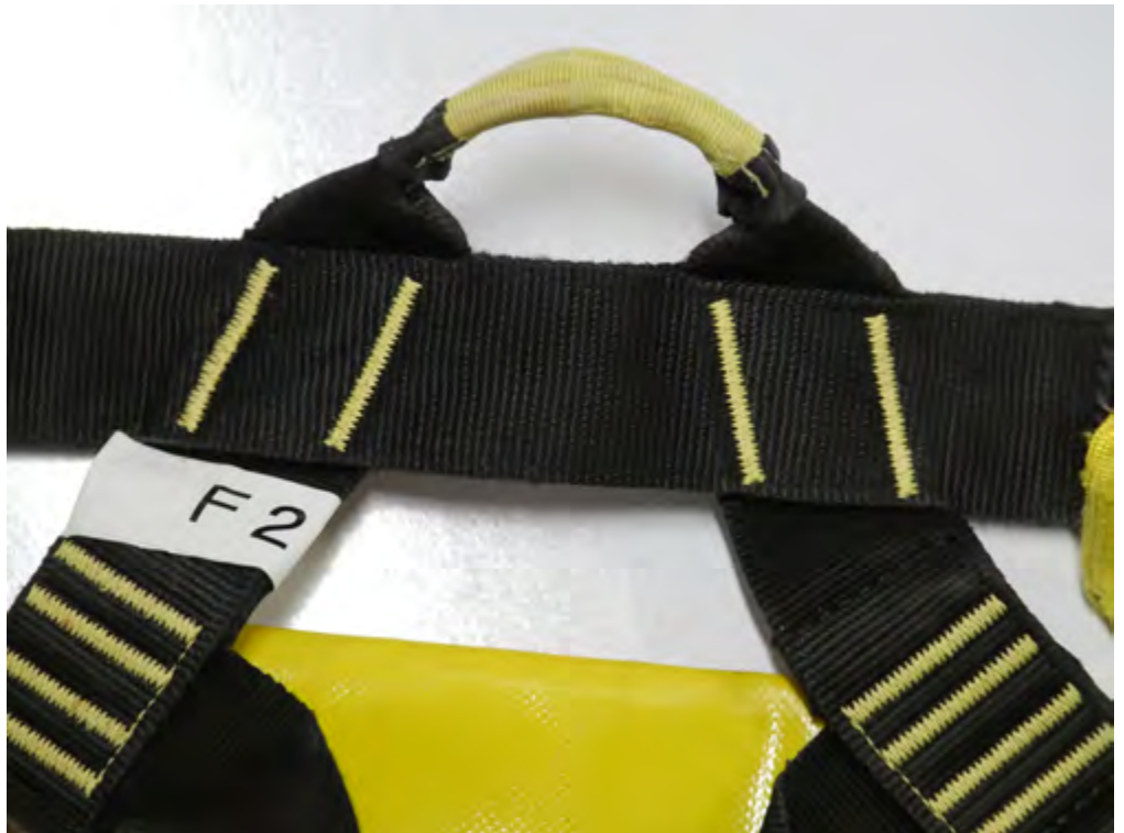
Figure 32: rupture à 287 kN harnais F2 Béal Hydroteam. Harnais peu usé avec 3 ans d'utilisation. Valeur de rupture critique : 197daN, 26% de la norme
