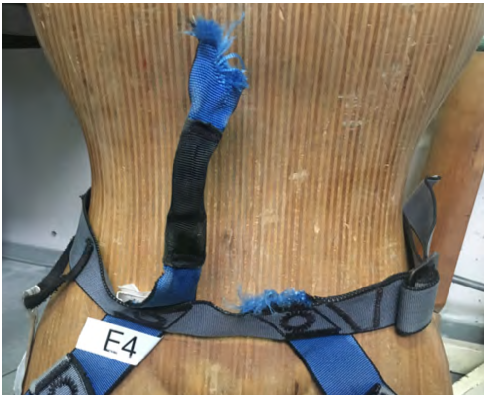
Figure 29: harnais (E4) rupture à 7,67 kN à la base du pontet
