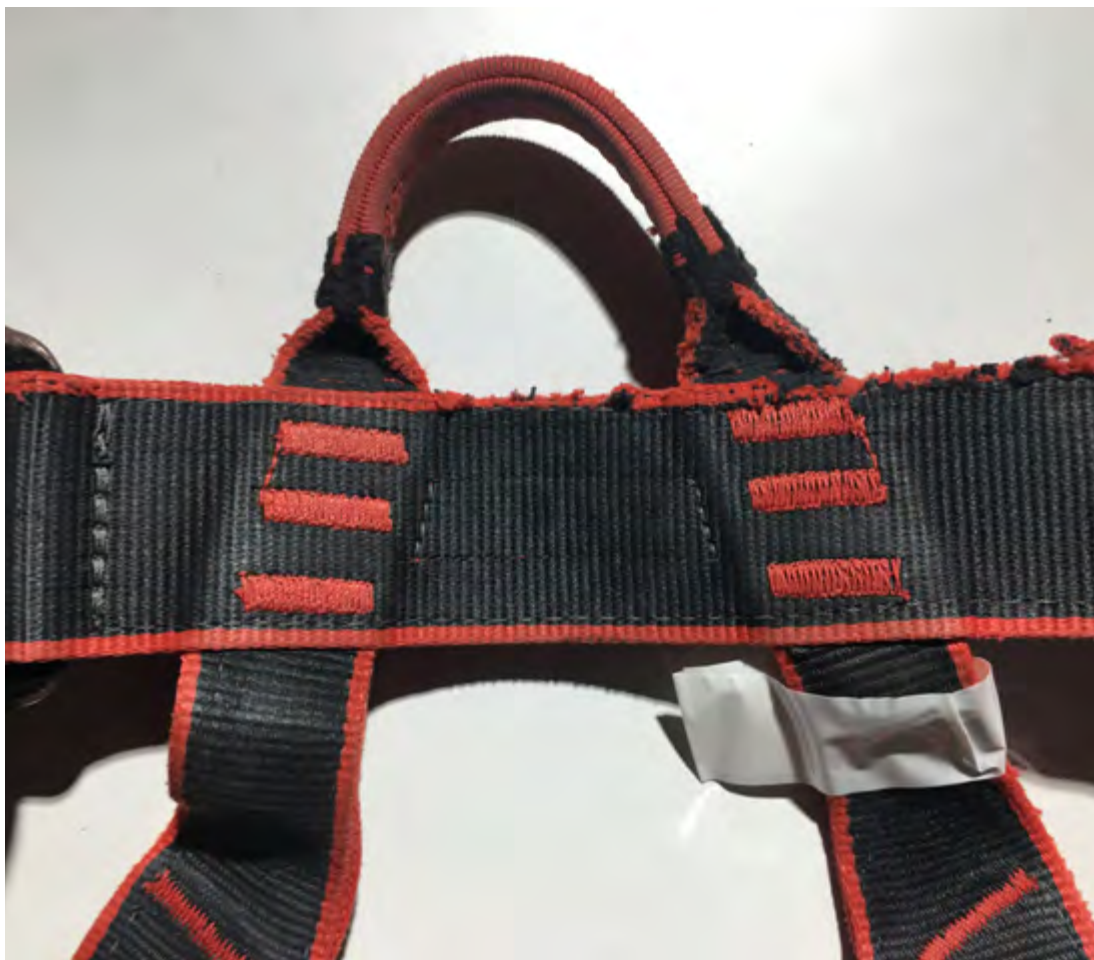
Figure 37: Détail coté interne du pontet, harnais mygale d'edelweiss. H7. Le pontet s'est rompu à 169 daN, soit 11% de la valeur requise par la norme. La ceinture s'est rompue à 580 daN soit 58% de la valeur requise par la norme (10 kN).
