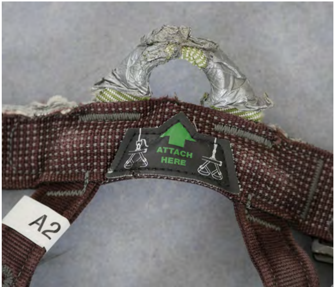
Figure 15: harnais Pandion Gordel de Petzl, (A2). Fabriqué en 2015. 4 années d'utilisation professionnelle. Etat très usé.
