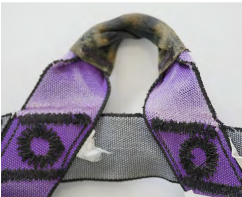
Figure 30: harnais (E5) 2013, 5 années d'utilisation, détail pontet. Rupture du pontet à 530 daN, rupture de la ceinture à 760 daN.
