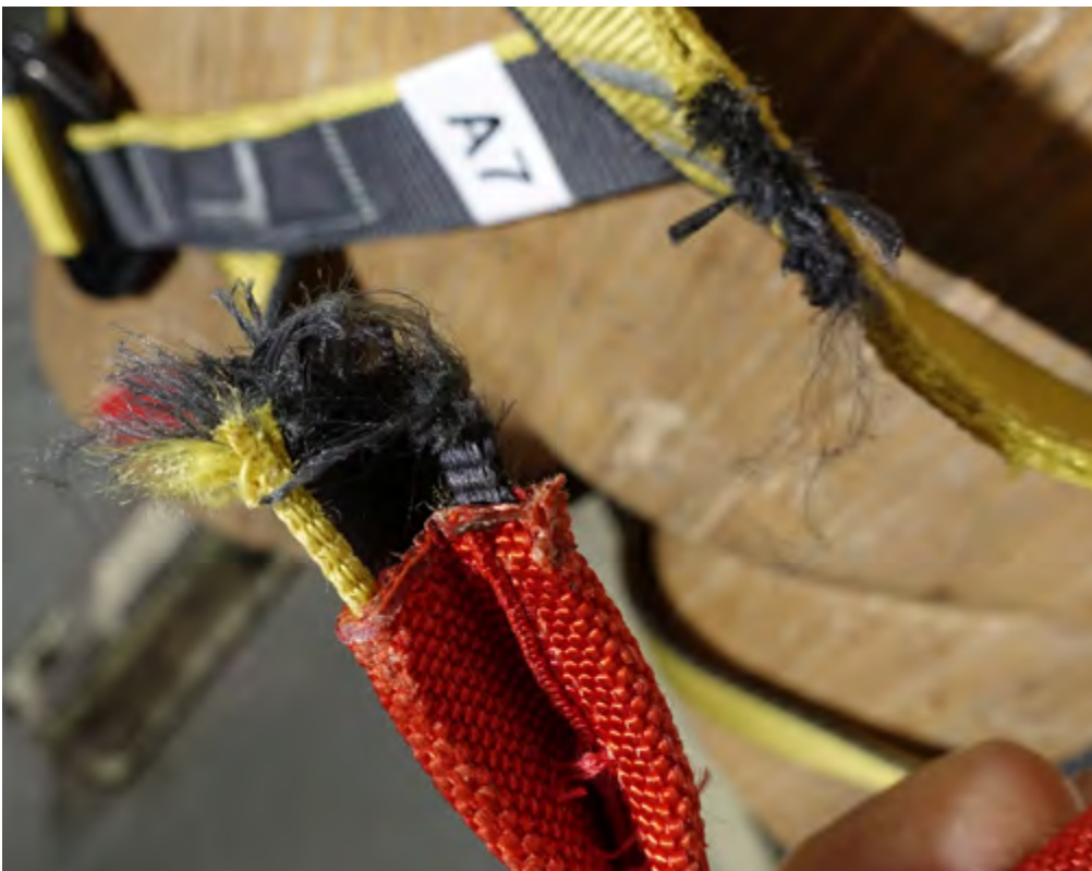
Figure 21: rupture à 9,98 kN du harnais A7 au niveau de la couture qui relie le pontet à la ceinture.
