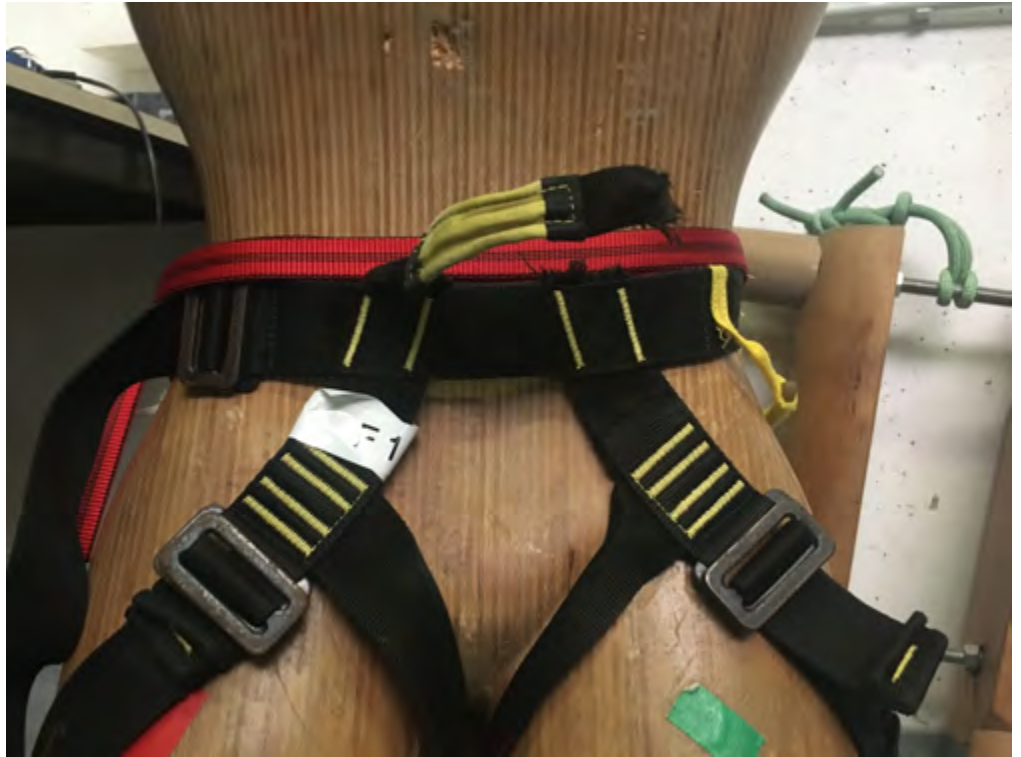
Figure 31: rupture à 394 kN harnais F1 Béal Hydroteam. Harnais peu usé avec 3 ans d'utilisation. Valeur de rupture critique : 26% de la norme.
