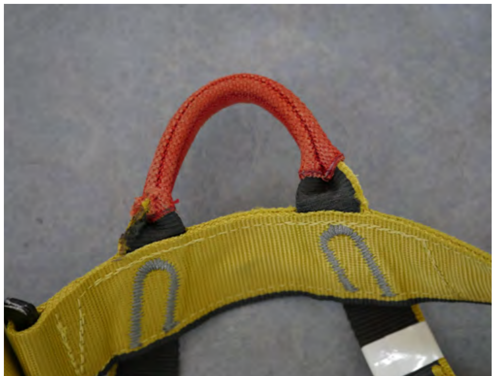
Figure 19: malgré un faible état d'usure ce harnais s'est rompu à 9.98 kN soit une valeur 35% inférieure à celle requise par la norme.
