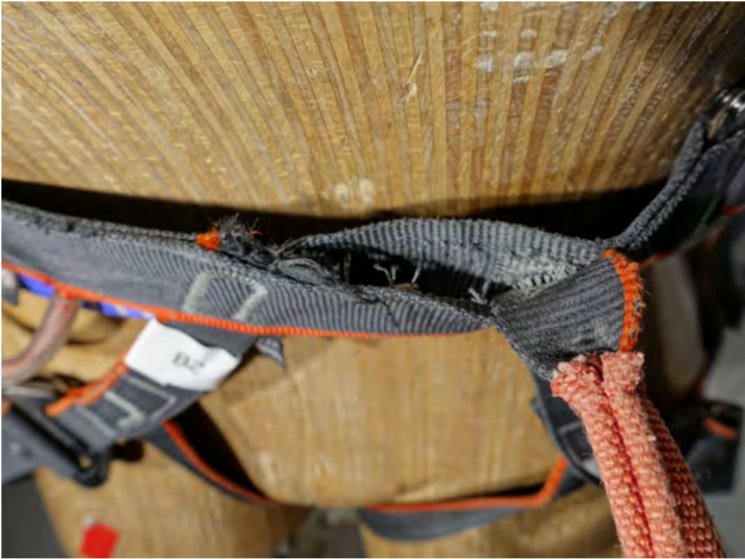
Figure 25: détail de ruptureharnais (B2) 6.33 kN
