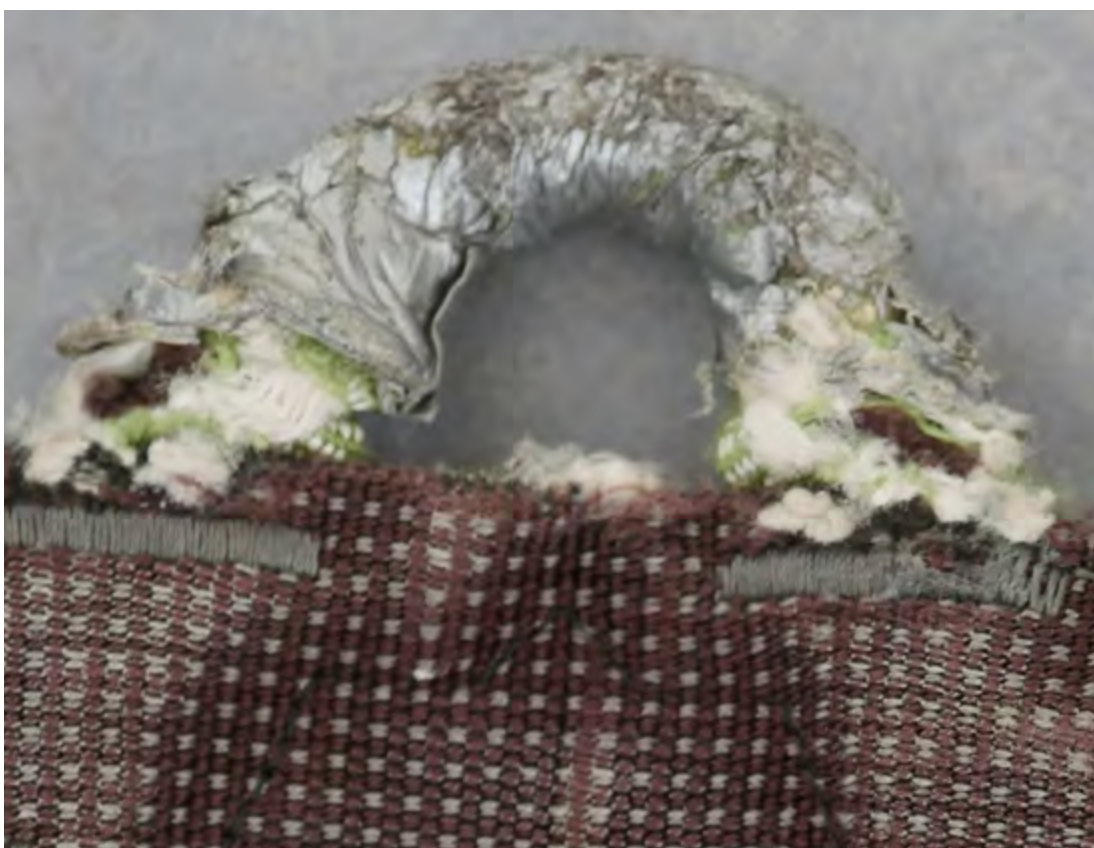
Figure 13: harnais A5, la pratique des toboggans sur le ventre use particulièrement la face ventrale du pontet, la sangle de protection est trouée et le pontet est abrasé. Malgré cette usure apparente la rupture a eu lieu à 19kN.
