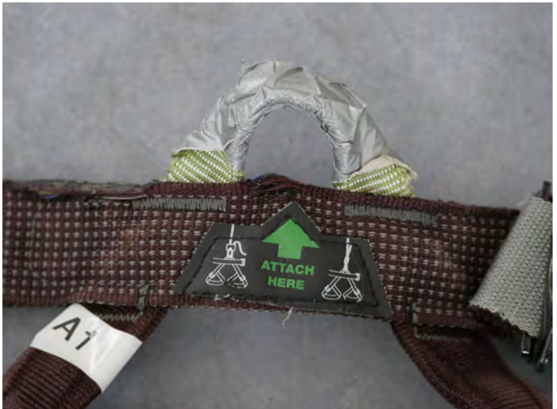
Figure 12: harnais A1 On note que le bord haut de la sangle ventrale se découd.
