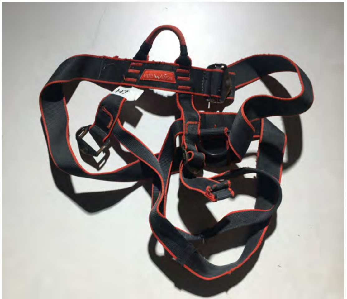
Figure 35: harnais mygale d'edelweiss. H7. utilisation 3 à 5 ans. Etat : usé.
