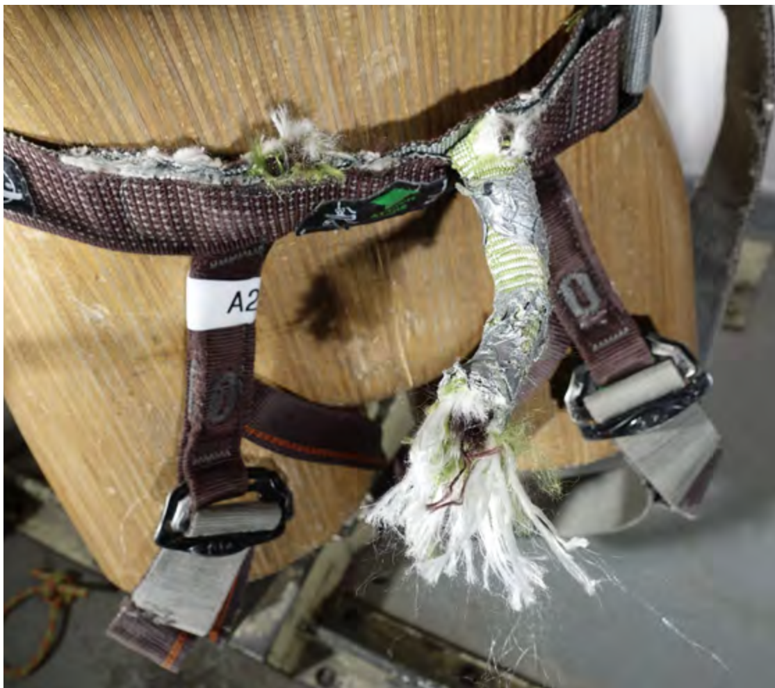
Figure 17: malgré une apparence très usée, le pontet s'est rompu à 22.33kN, soit 48% de plus que la valeur demandée par la norme.
