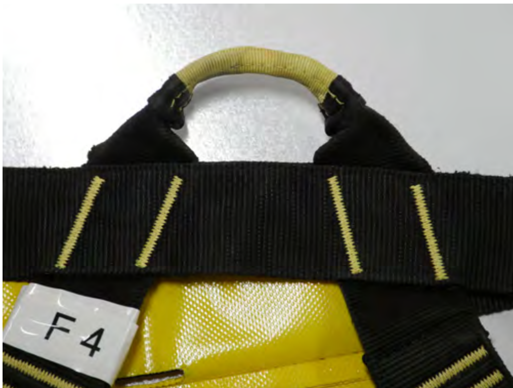
Figure 33: rupture à 149 kN tirage désaxé harnais F4 Béal Hydroteam. Harnais peu utilisé avec 3 ans d'utilisation . Valeur de rupture très critique : possibilité de rupture lors d'une mise en tension brutale (glissade avec une longe non tendue).
